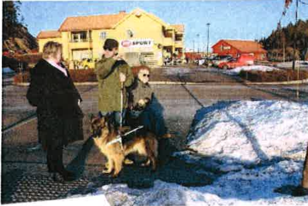
Konkret eksempel på usammenhengende gangsystem på Brokelandsheia. Fortauet som syns i bakgrunnen leder en over veien og rett inn i en snøhaug, vanligvis en parkeiringsplass.
